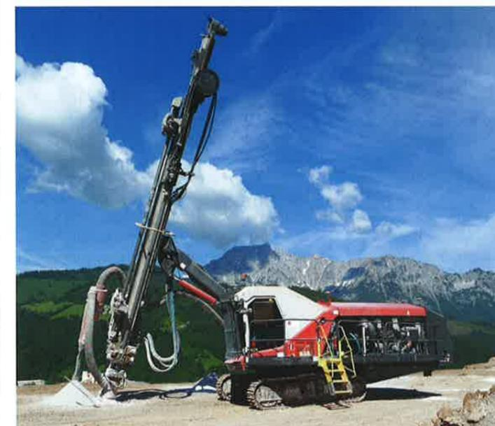
Maßgeschneidert für den Mining Einsatz punktet das Hochdruck DTH Bohrgerät Pantera 6400 von Sandvik am Erzberg unter anderem mit der großen Rückzugskraft der Lafette, der bei nicht standfesten Bohrlöchern besondere Bedeutung zukommt.
