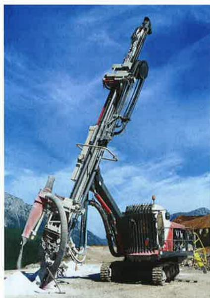
Durch den Einsatz des Sandvik Sustainability Package (SP) wird eine Kraftstoffersparnis von ca. 50% gegenüber Bohrgeräten ohne dieses System ermöglicht.
